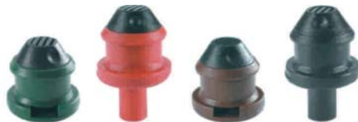
Caudales: 2.2 , 2.8 , 3.7 y 7.9 l/h. Intervalo Pres. Autocompensación: 6 a 35 mca. Intervalo recomendado: 8 a 30 mca.
